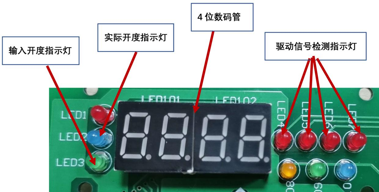
图 6、信息显示区内部结构图
