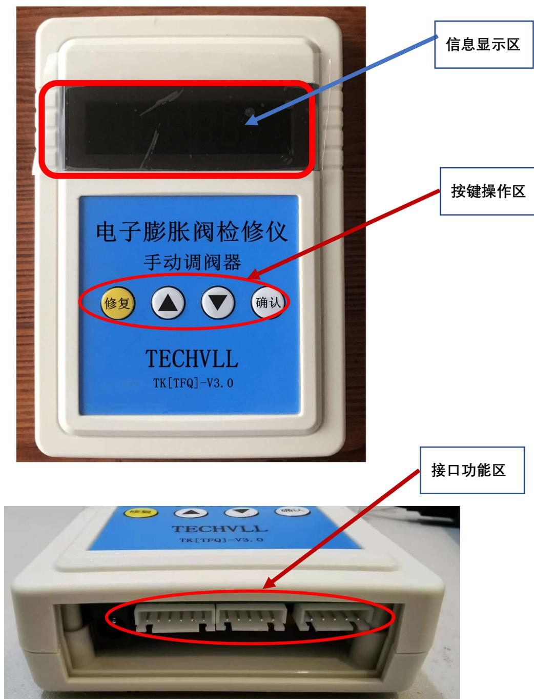
图 5、检修仪功能结构示意图
