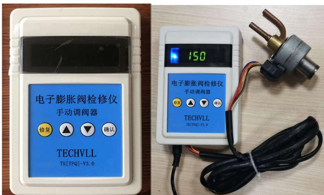
图 4、第三代电子膨胀阀检修仪
