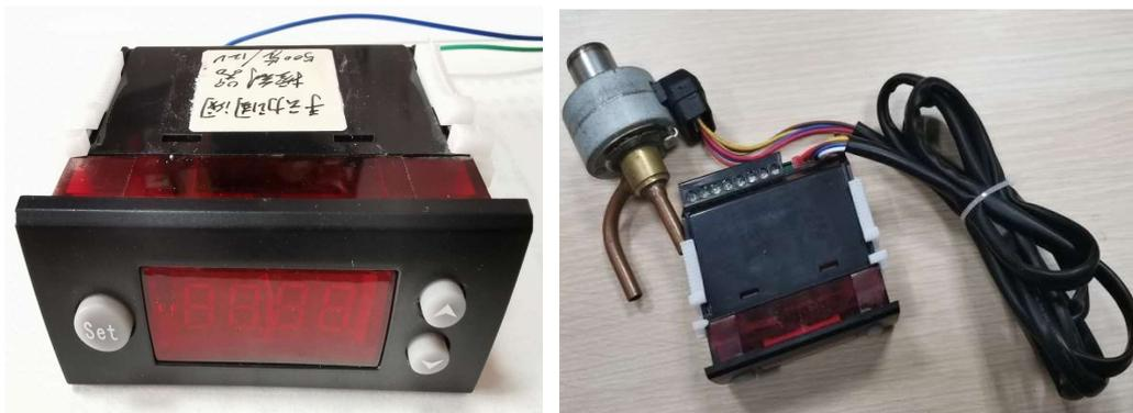
图 3、第二代电子膨胀阀检修仪
